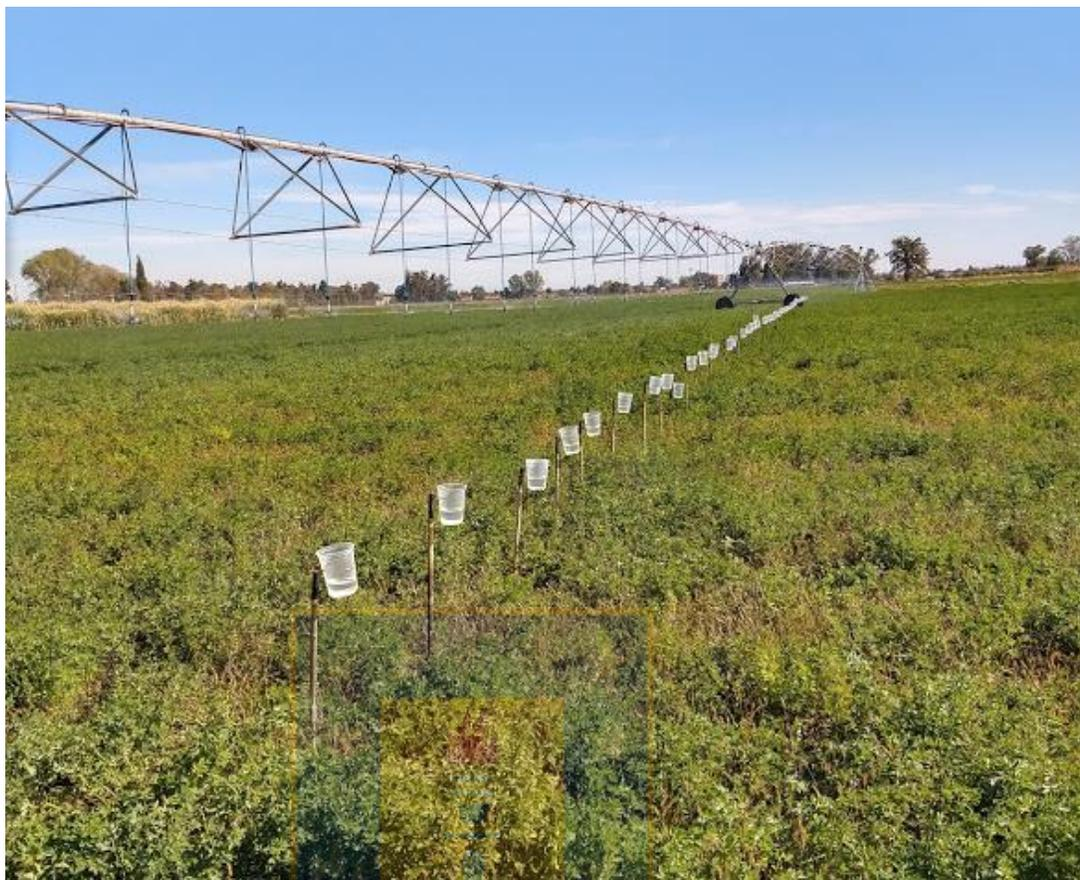
Figura 17. Disposición de los vasos recolectores para la prueba de aplicación de una lámina de agua de 40 mm en el pivote del ensayo. Fuente: Elaboración propia.
