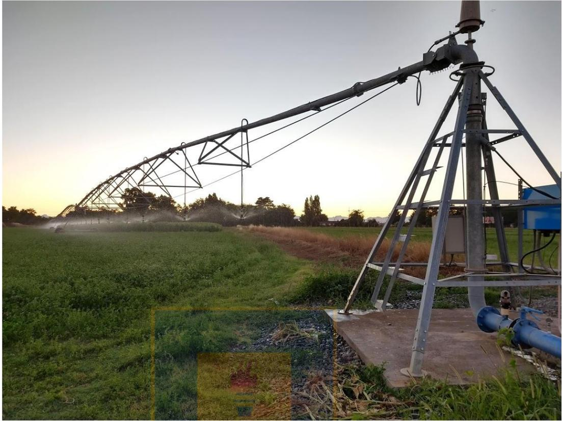
Figura 3. Ejemplo de un pivote central donde se observa la estructura, la tubería principal y el paquete de aspersores. Fuente: Elaboración propia.
