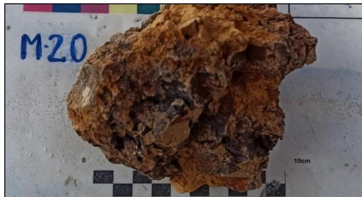
**Figura 4.19.** Muestra M-20 correspondiente a brecha hidrotermal lixiviada de la Fase 13.
