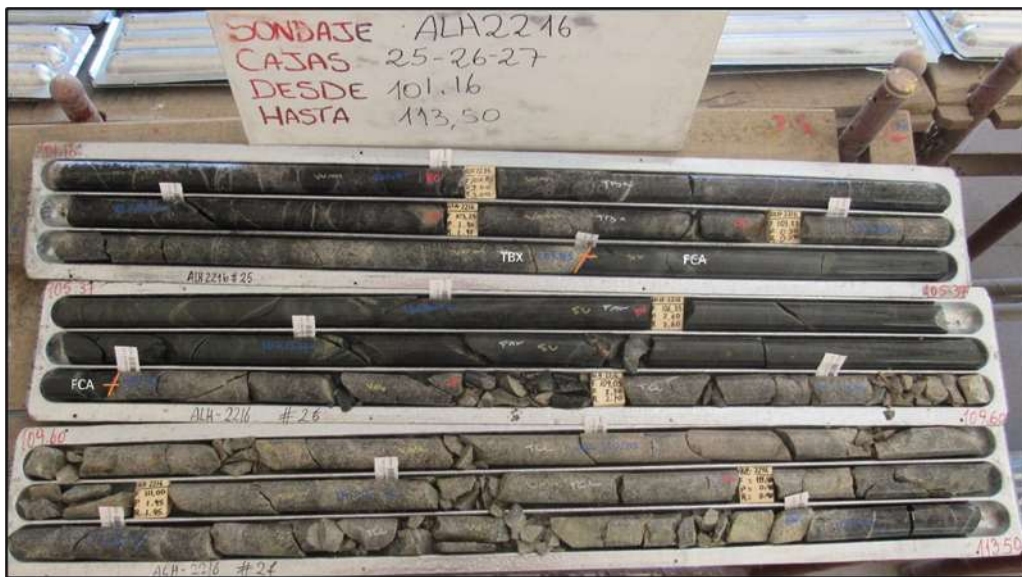
Fotografía 1: Contacto entre Toba Brechosa y Filón Casino (marcado en color anaranjado). Tomado de los archivos de Minera Florida.
