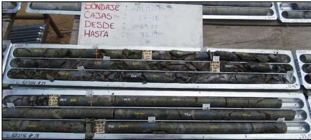
Foto 3: Contacto entre Toba Brechosa y Brecha Hidrotermal (en color anaranjado). Tomado de los archivos de Minera Florida.
