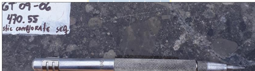
Figura 3.7: Paraconglomerado de color gris oscuro, matriz soportado, polimíctico y pobremente seleccionado perteneciente a la secuencia epiclástica. Formado por clastos subredondeados de 1 a 5 cm provenientes de la unidad BAVS y RVS.
