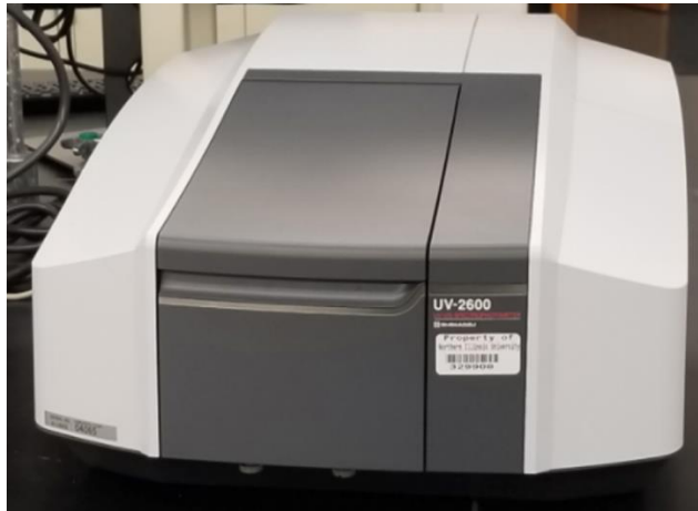
Fig 4.7: Espectrofotómetros UV Visible Shimadzu UV-2600.
