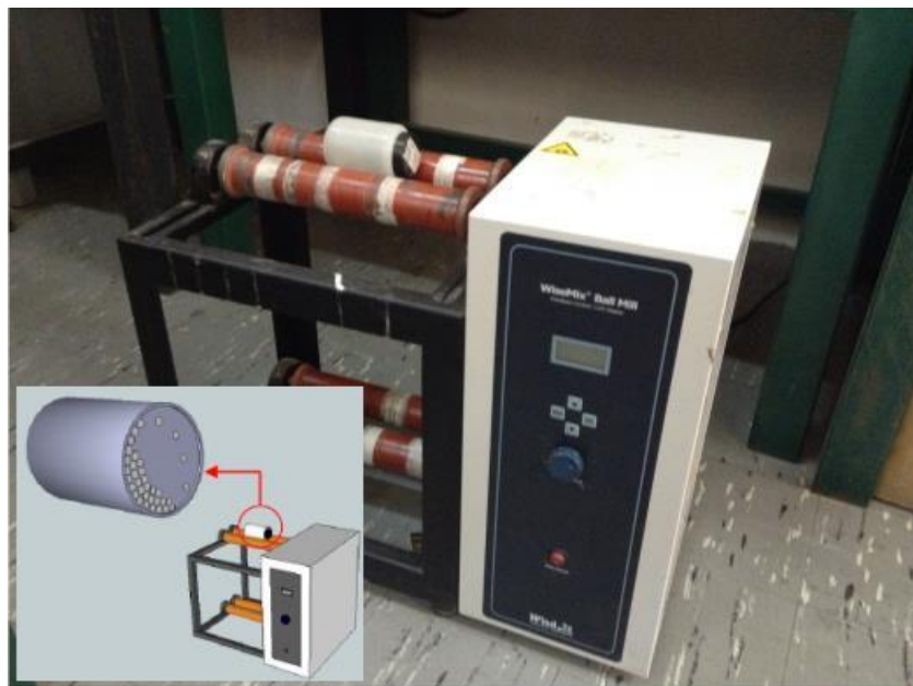
Fig 4.4: molienda de triple rodillo Wisemix Ball Mill.
