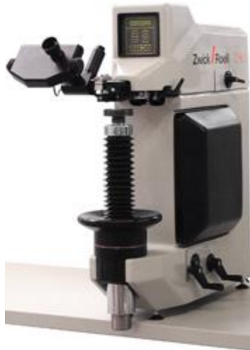
Fig 4.9: Microdurómetro Zwick/Roell 8187.5 ZHU.
