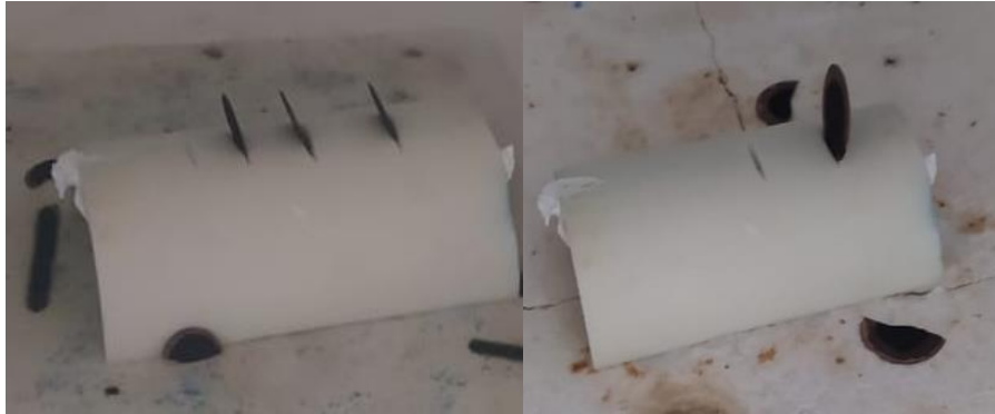
Fig 7.5: Quiebre mecánico de las muestras LSCM/LSGM/LSM ( \text{La}_{0.6}\text{Sr}_{0.4}\text{MnO}_3 ) en el tratamiento de co-sinterización a 1200^\circ\text{C} por 3H.
