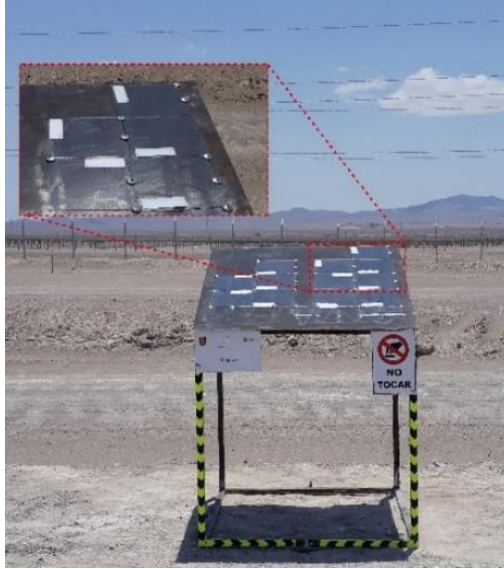
Figura 6. Cupones de vidrio montados en la estructura de soporte en El Salvador PV.
