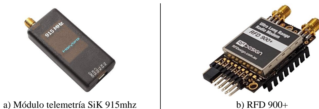
Figura 5.8: Radio telemetría estándar vs RFD900+ (Fuente: Elaboración propia)
