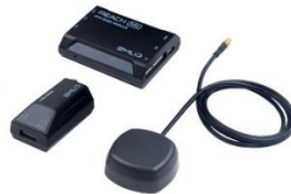
Figura 4.5: GPS-RTK Emlid Reach M+ (Fuente:[24])
