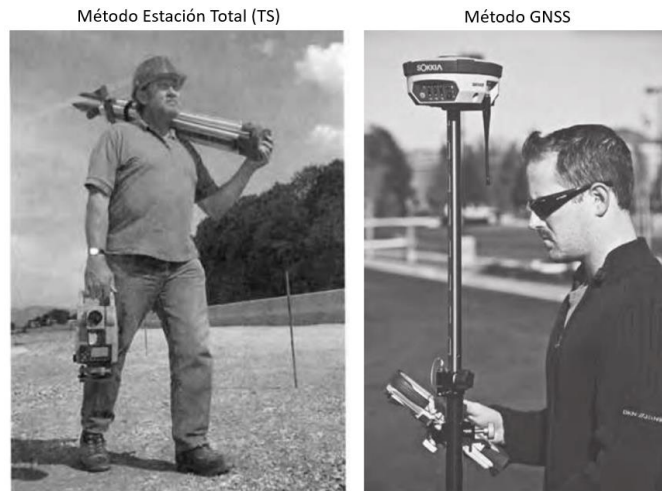
Figura 2.2: Levantamientos topográficos con TS y GNSS. (Fuente:[7])
