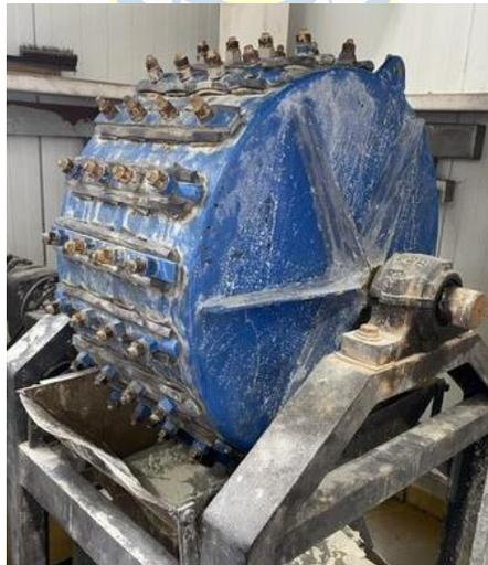
**Figura 3.2. Molino de bolas utilizado en el proceso de trituración de residuos**
