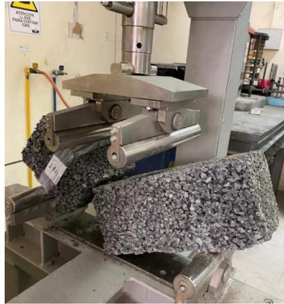
**Figura 3.10. Probeta ensayada a resistencia a la flexotracción**
