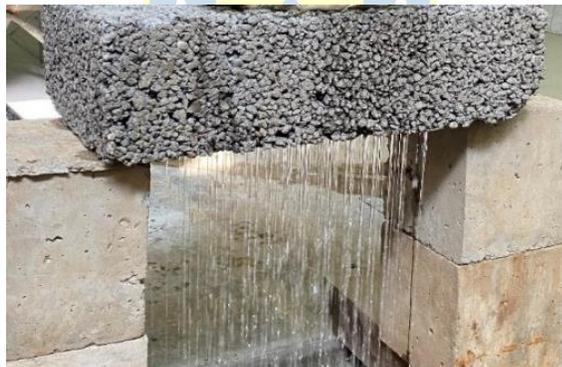
**Figura 2.1. Hormigón poroso**
