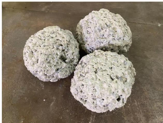
**Figura 4.8. Efecto del Ensayo de Resistencia a la abrasión según ASTM C1747**
