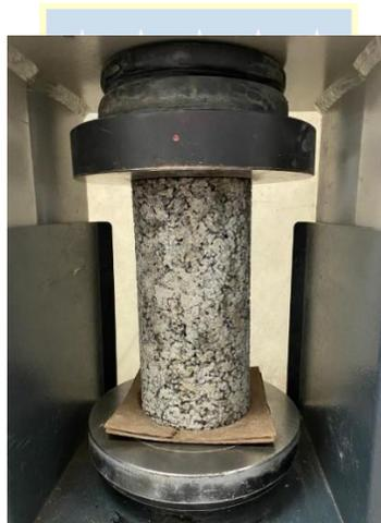
Figura 3.9. Probeta ensayada a resistencia a la compresión
