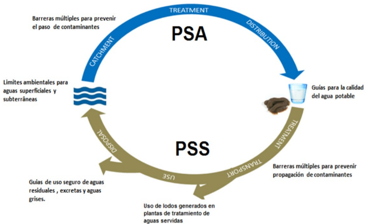
Figura 1. Círculo del uso del consumo humano del agua y generación de aguas servidas considerando las herramientas de gestión de riesgos PSA y PSS. Extraído de presentación de Teófilo Monteiro, OPS/OMS – ETRAS, Lima – Perú, Julio 2015
