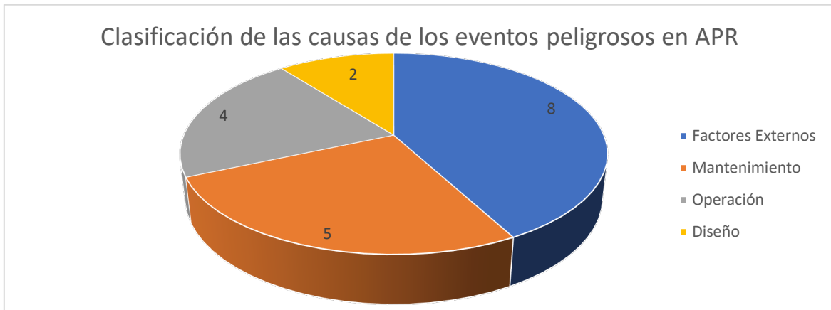
Figura 21: Clasificación de las causas de los eventos peligrosos. Fuente: Elaboración Propia, en base a visita Terreno Comité APR Villa Mercedes, 2021; Comunicación Interpersonal con Operador APR Villa Mercedes, 2021.
