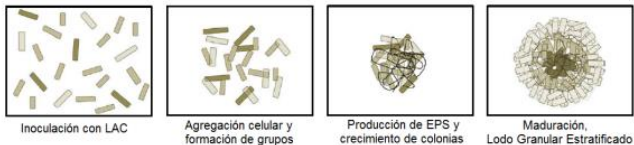
Figura 29. Representación esquemática de las etapas operativas de SBR. (condiciones operativas que contribuyen a la formación de los gránulos aerobios) y de los mecanismos involucrados en el proceso de granulación aeróbica, adaptado de (Duarte Castro, 2022)
