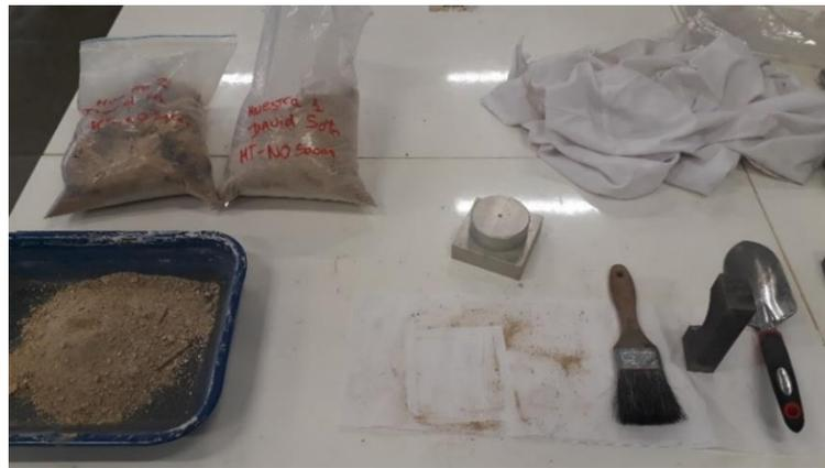
**Figura 90. Preparación de las muestras de suelos para ensayarlos.**
