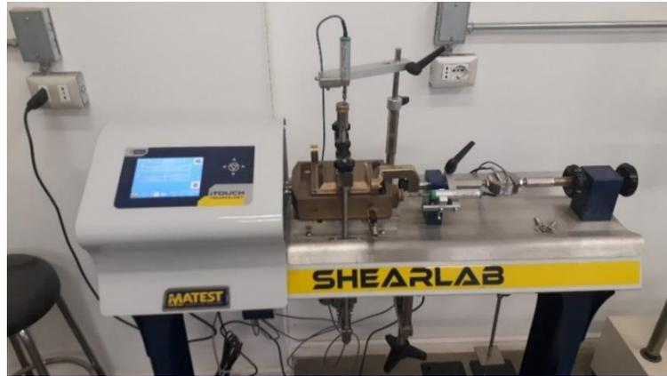
**Figura 89. Máquina Shearlab con la que se realizó los ensayos de corte para 1, 5, 10 y 15 Kg.**
