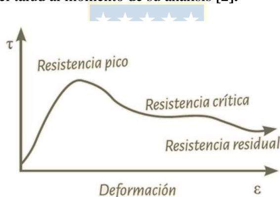
Figura 1. Gráfico de Tensión deformación en ensayos de corte. [2]
