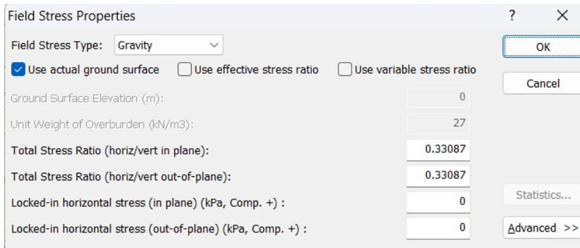
Figura 48. Configuración de la ventana "Field Stress Properties" de RS2.
