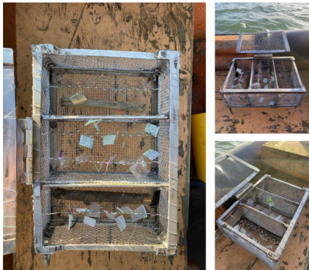
Figura 2: Jaula de acero inoxidable con los diferentes fragmentos de plástico (PET, LDPE y PS) en su interior.
