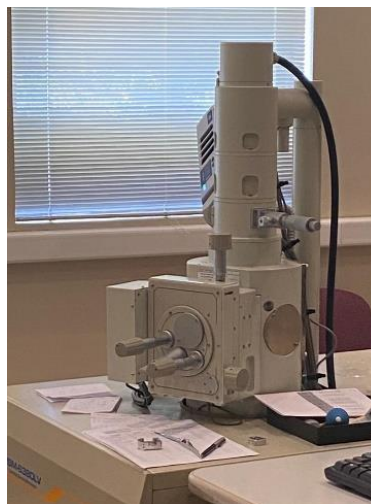
Figura 19. Microscopio electrónico de Barrido JEOL JSM-6380 LV
