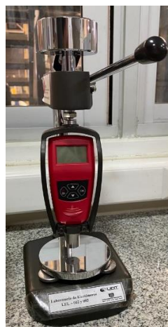
Figura 15. Durómetro digital EHS Tipo A.
