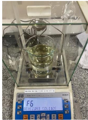
Figura 14. Balanza analítica AS 220.R2 implementada con kit de densidad.
