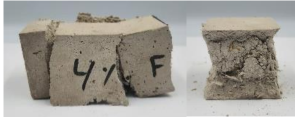
Figura 46: Prueba de compresión de prisma roto de muestra de concreto con 4% de cáñamo
