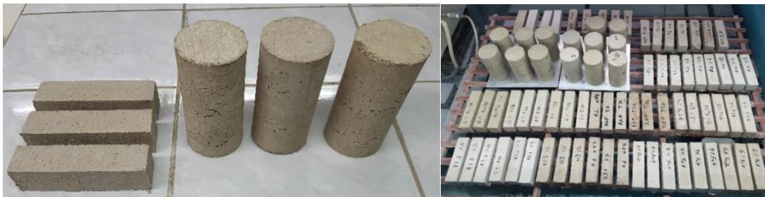
Figura 10: Izquierda: muestras de ensayos de concreto de cáñamo. Derecha: probetas sobre una piscina de curado.
