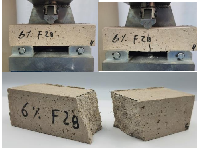
Figura 19: Ensayo de resistencia a la flexión con probeta prismática de dosificación 6% de cáñamo.
