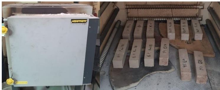
Figura 14: Muestras de concreto de cáñamo sometidas a altas temperaturas dentro de una mufla
