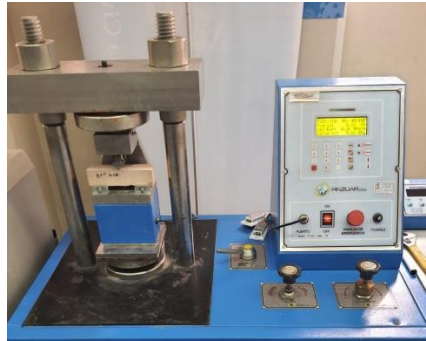
Figura 11: Maquina doble rango para ensayos de concretos, modelo PC-42-D.
