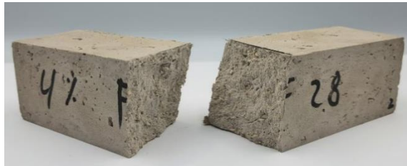
Figura 43: Prueba de flexión de muestra de concreto con 4% de cáñamo
