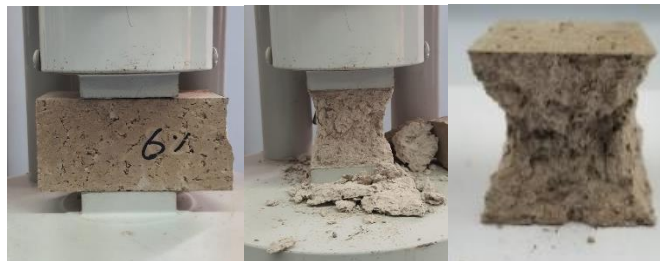
Figura 35: Ensayo de resistencia a la compresión con probeta de prisma roto en flexión de dosificación 6% de cáñamo tras exposición a 400°C.
