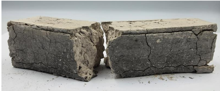
Figura 31: Rotura de muestras de ensayos por choque térmico
