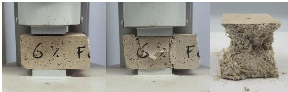
Figura 22: Ensayo de resistencia a la compresión con probeta de prisma roto en flexión de dosificación 6% de cáñamo.
