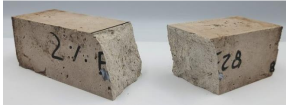
Figura 42: Prueba de flexión de muestra de concreto con 2% de cáñamo
