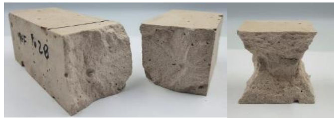
Figura 48: Pruebas de flexión y compresión tras exposición a 400°C de muestra patrón
