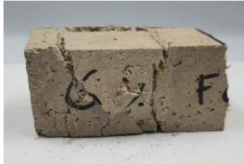
Figura 47: Prueba de compresión de prisma roto de muestra de concreto con 6% de cáñamo
