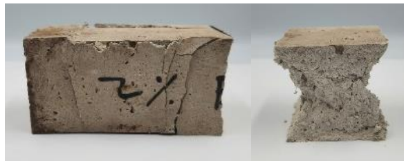
Figura 45: Prueba de compresión de prisma roto de muestra de concreto con 2% de cáñamo
