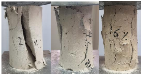
Figura 44: Prueba de compresión de muestra de concreto con 2%, 4% y 6% de cáñamo
