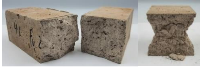
Figura 50: Pruebas de flexión y compresión tras exposición a 400°C de muestra de concreto con 4% de cáñamo
