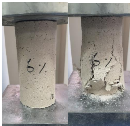
Figura 25: Ensayo de resistencia a la compresión con probeta cilíndrica de dosificación 6% de cáñamo.
