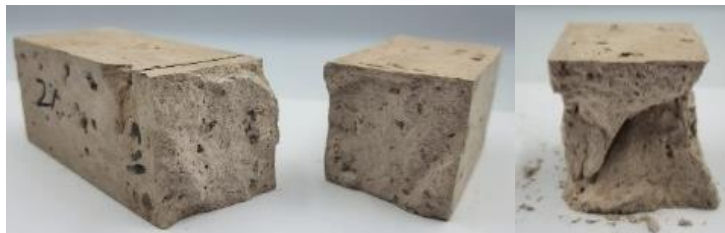
Figura 49: Pruebas de flexión y compresión tras exposición a 400°C de muestra de concreto con 2% de cáñamo
