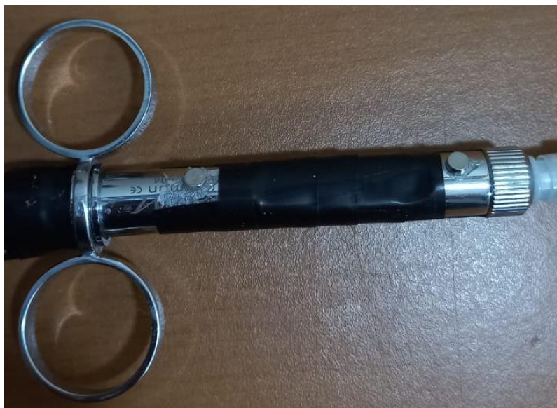
Fig. 3.24. Posición de los imanes de Neodimio sobre la jeringa "carpule".
