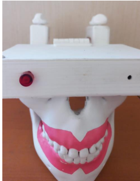
Fig. 3.9. Sistema de aviso de punción exitosa en donde se observa el Led color rojo y el agujero del buzzer [5].
