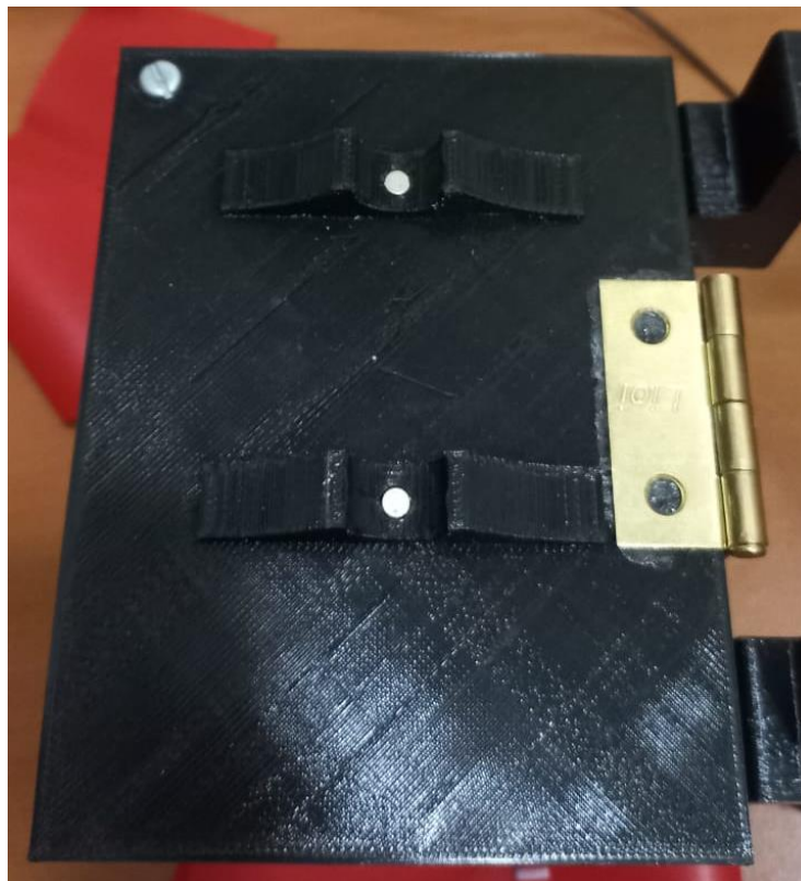
Fig. 3.20. Vista superior de la caja, en donde se observa el sistema de sujeción de la jeringa “carpule”.
