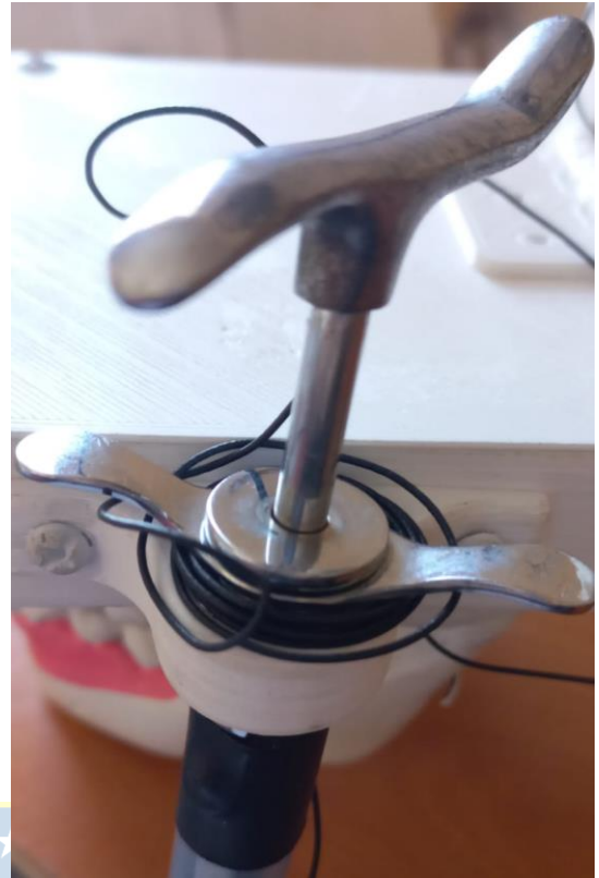
Fig. 3.5. Vista superior del soporte de la jeringa [5].
