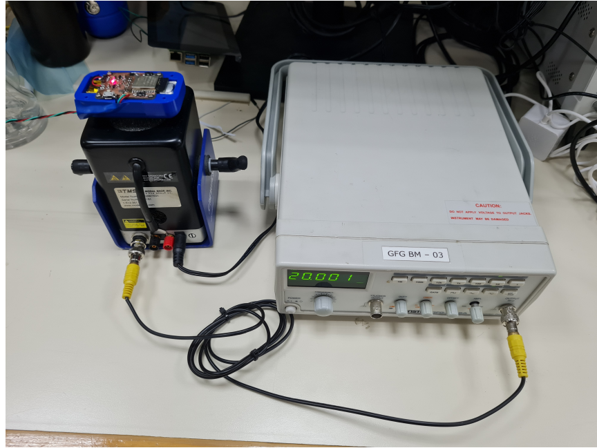
Fig. 5.6: Entorno de pruebas con Mini SmartShaker K2007E, GW INSTEK GFG-8216A y la placa embebida.
