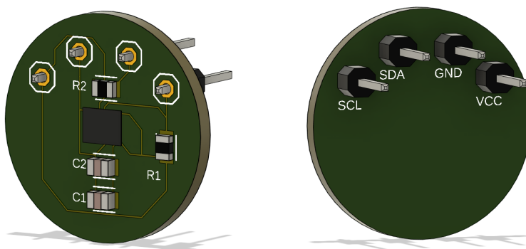
Figura 7.7: Placa de desarrollo BMI270 preparada para comunicación I^2C .
