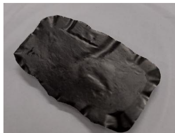
Figura 4.3: Hidrogel formado por mezcla de CNF y rGO
