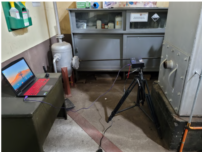
Fig. 4.4: Set-up óptico para la adquisición de espectros reales.
