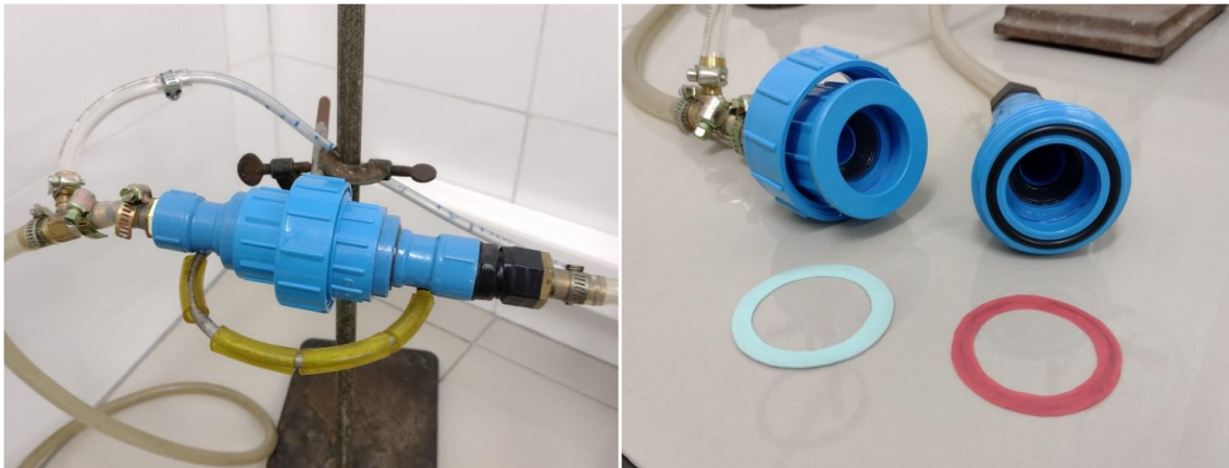
Figura 8.9: Cartucho para muestras cerrado (Izquierda) y abierto (Derecha) junto con sus sellos de goma.
