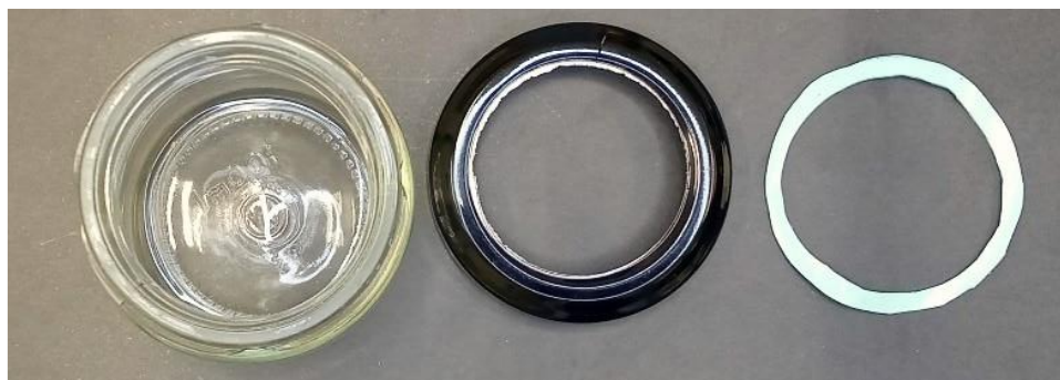
Figura 4.10: Frasco de vidrio modificado y sellos de silicona usados para la prueba de WVTR.
