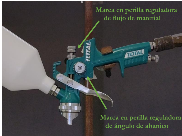
Figura 8.1: Acercamiento al nebulizador, indicando marcas en las perillas reguladoras de flujo y ángulo de abanico de material.
