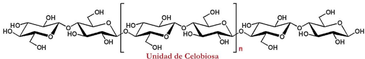
Figura 3.5: Estructura molecular de la celulosa [11].
