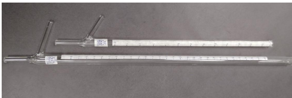
Figura 8.11: Flujómetros alternativos de menor volumen.
