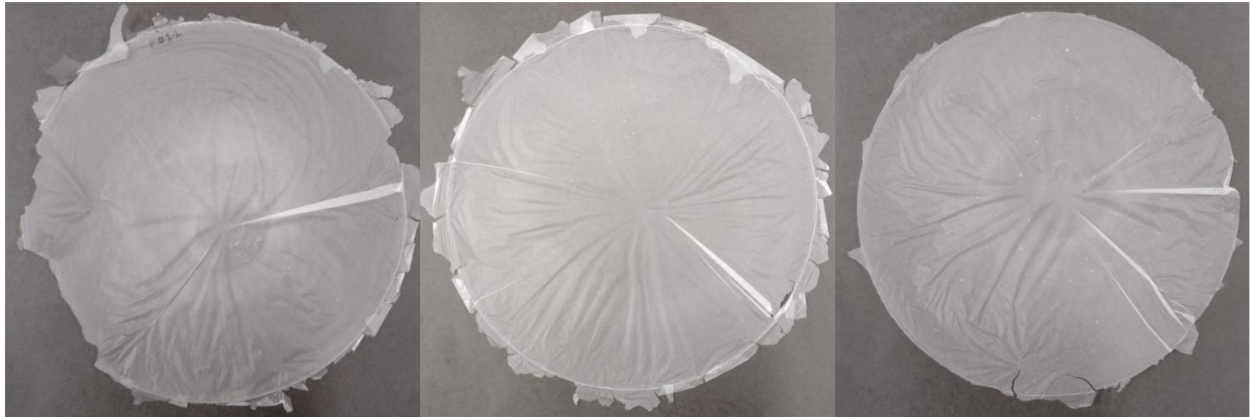
Figura 8.7: Ejemplos de películas de NFC fallidas a causa de problemas de tensión en la tela.
