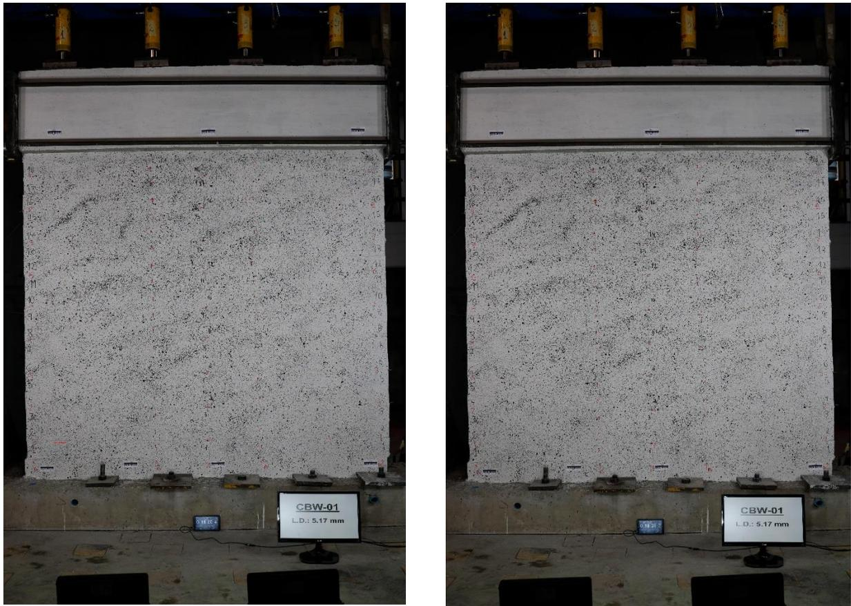
(a) Mapas de agrietamiento muro CLBW01 en estado de primera aparición de daño (estado cargado a la izquierda, y estado descargado a la derecha)
