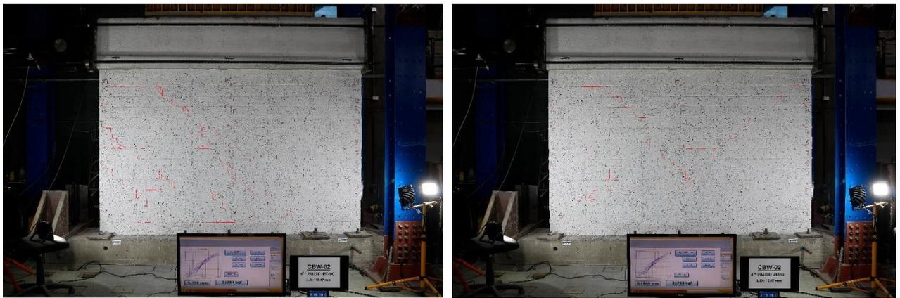
(b) Mapas de agrietamiento muro CLBW02 en 97% de razón de carga horizontal máxima (estado cargado a la izquierda, y estado descargado a la derecha)
