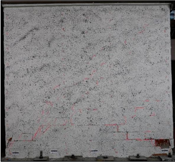
(a) Imagen de muro CLBW01 con capa mapa de agrietamiento trazado
