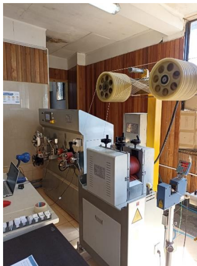
Figura 2.3 Bobinado, controles de diámetro y acumulador Fuente: Elaboración propia
