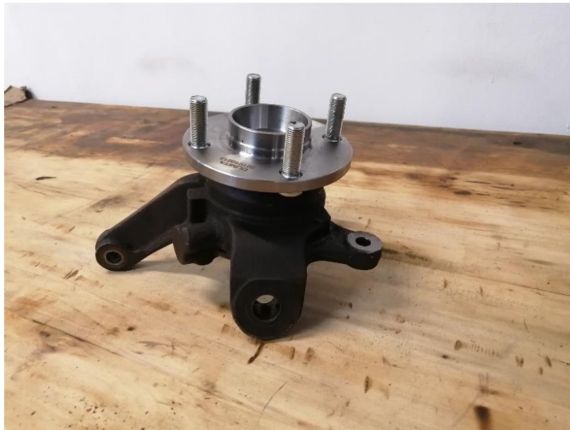
Figura 4.14. Recambio de maza y rodamientos delanteros.
