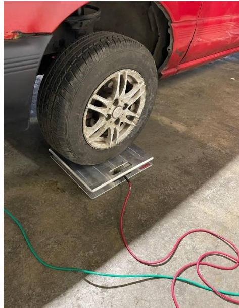
Figura 2.2. Medición de las masas del vehículo.
