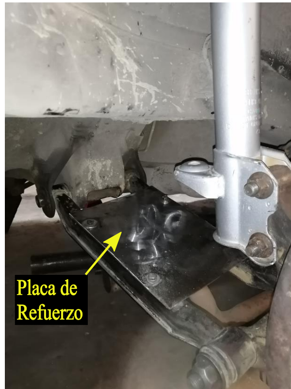
Figura 4.16. Refuerzo en el brazo inferior de la suspensión trasera.
