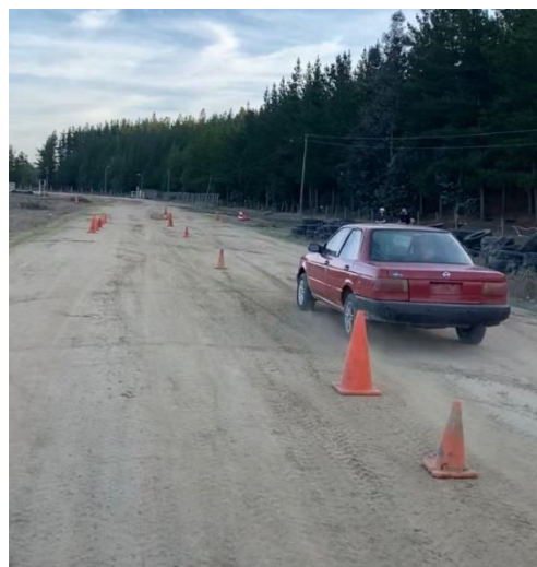
Figura 2.5. Realización de la prueba del alce.
