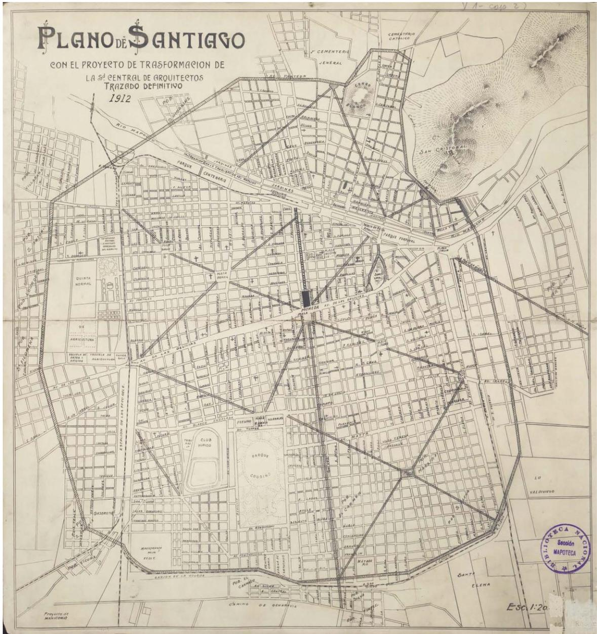
Anexo Figura 2.- Plano de transformación de la conectividad de Santiago de 1912 con líneas construidas y proyectadas del ferrocarril de Circunvalación
