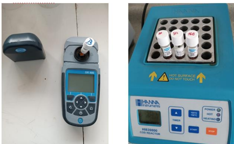
Figura 21: Equipo DR 900 y Termo reactor HACH, Estados Unidos. Fuente: HACH
