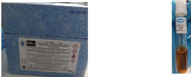
Figura 20: Kit de tubos de ensayos para determinar DQO, Estados Unidos. Fuente: HACH
