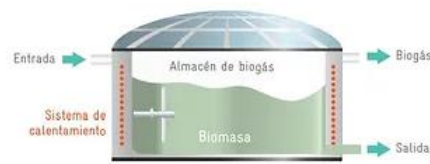
Figura 15: Reactor continuamente agitado. Fuente: (GIZ, 2018)
