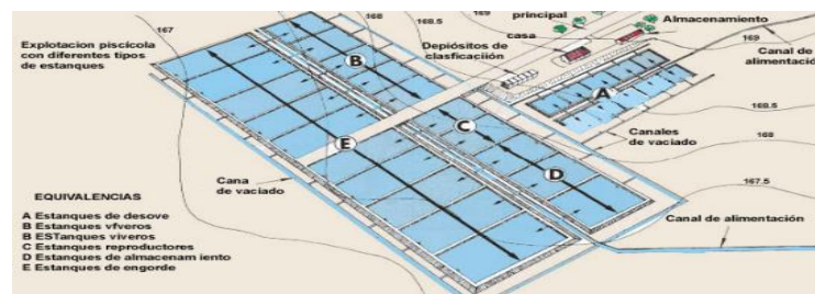
Figura 1-5: Ejemplo disposición instalación productiva
