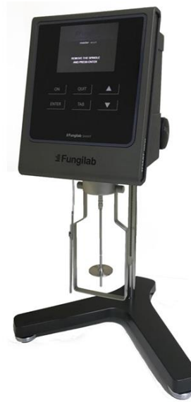
Figura 44 Viscosímetro rotacional Fungilab
