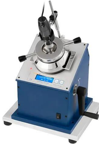
Figura 18 Ensayo de embutición Cupping Tester
