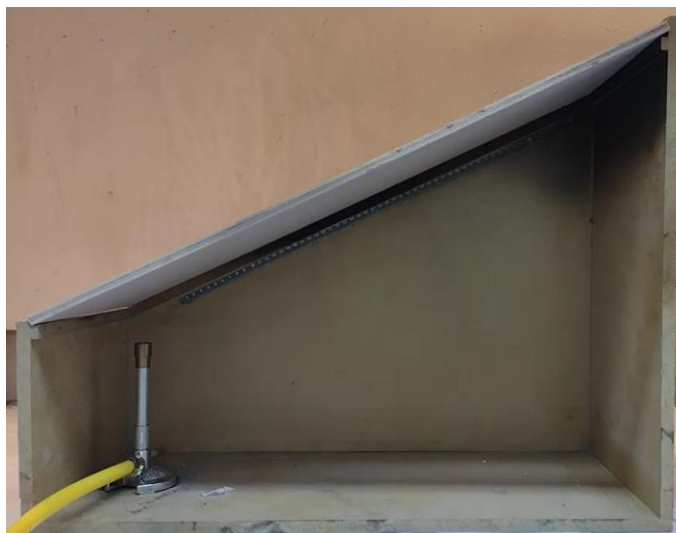
Figura 12 Túnel inclinado ASTM D3806-19 a
