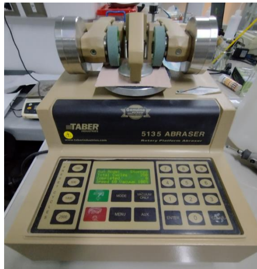
Figura 14 Taber abraser ensayo abrasión
