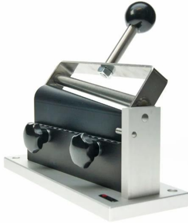
Figura 17 Mandril cónico prueba flexibilidad
