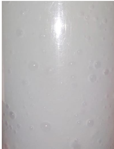
Figura II.1. Mezcla de 1 ml de PAAS y NFC por agitación mecánica a 1000 rpm
