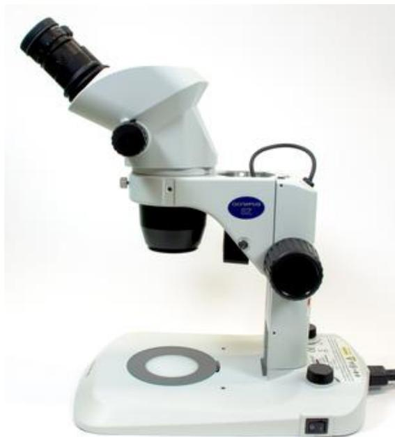
**Figura N° 6:** Estereomicroscopio binocular.
