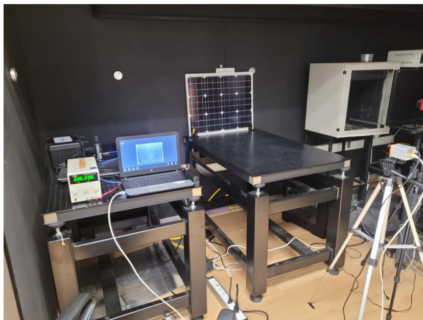
Figura 3.3: Detección de radiación en Panel Solar con cámara IR
