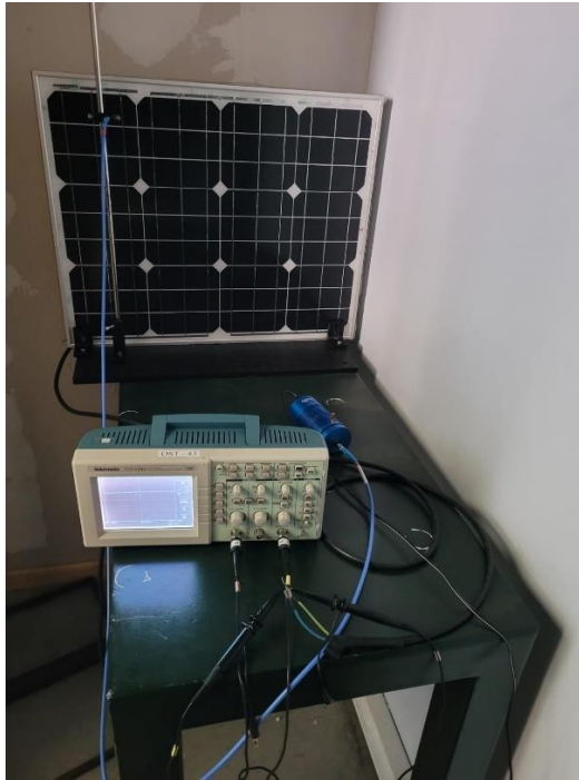
Figura 3.4: Detección de voltaje de salida al iluminar cada celda con láser verde
