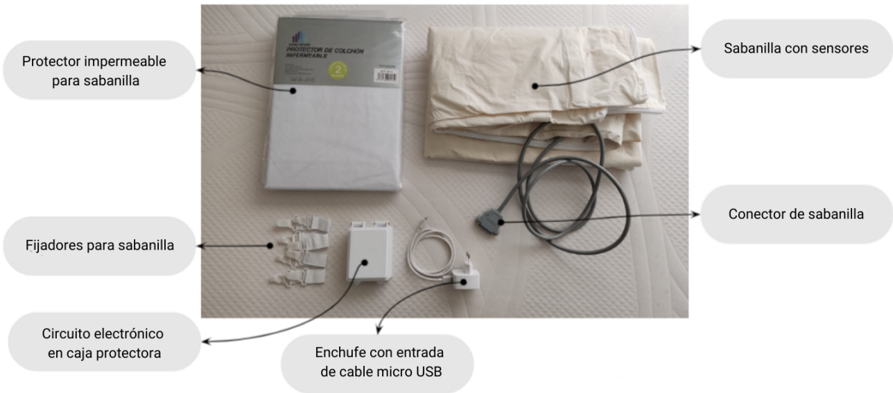
Figura 3.2: Kit de instalación de sabanilla de monitoreo para Proyecto SISCAP-CP.
