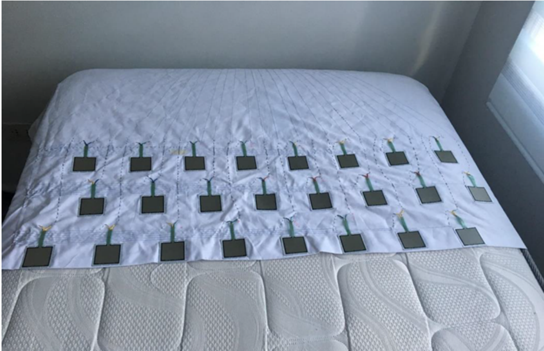
Figura 2.2: Malla de sensores de presión posicionado sobre el colchón a la altura del tórax (sin funda) [18].
