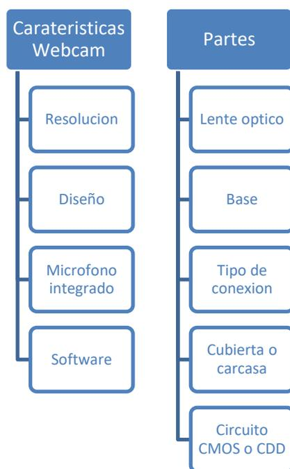
Figura 11: Características y partes de una webcam (Fuente: Elaboración propia en base a estudio realizado)
