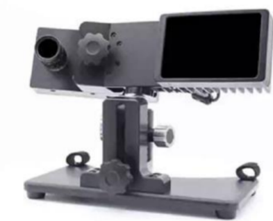
Figura. 1.4: Equipo de Registro Movimiento Ocular Eyelink1000 [21], utilizado en estudio lector [16].
