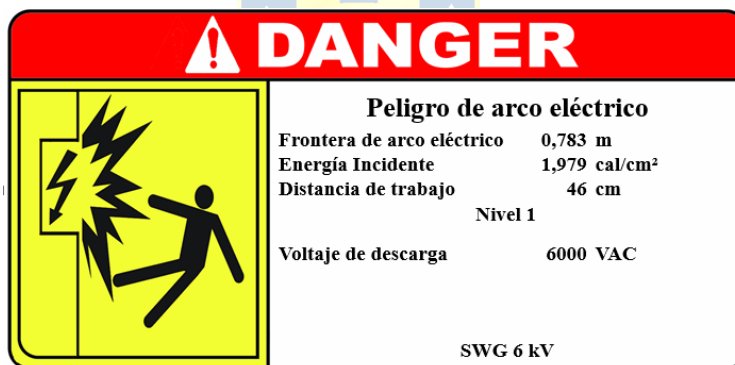
Figura 6.5.1 Etiqueta de peligros barra SWG 6 kV.
