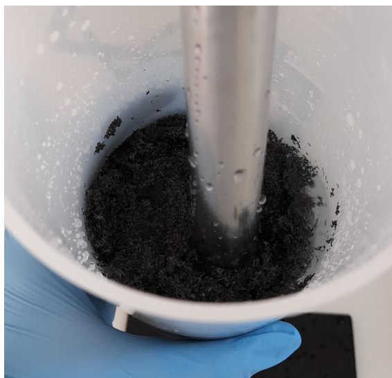
Figura 3: Molienda de PE a MPs con homogeneizador ultraturrax.
