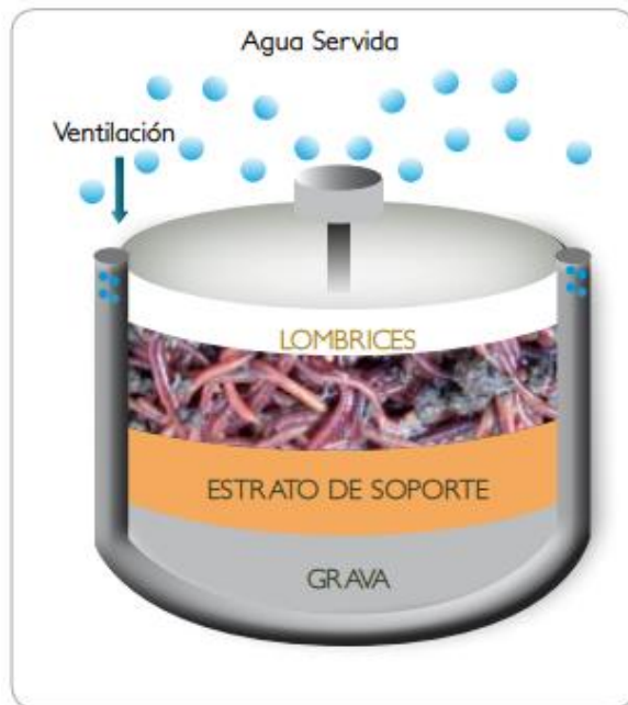
Figura 10. Esquema simplificado de un lombrifiltro.
