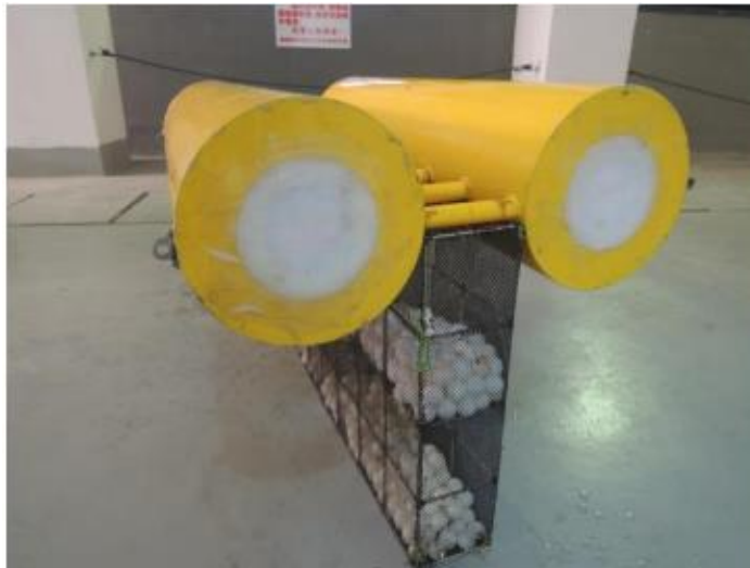
Figura 2.5 Modelo de rompeolas experimental
