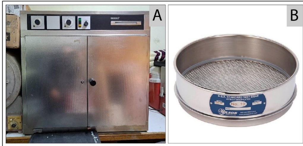
Fotografía 3.1: Instrumentos utilizados para la preparación de la muestra. A. Horno Laboratorio de Sedimentología Departamento de Ciencias de la Tierra; B. Tamiz malla N°10 de 2mm.
