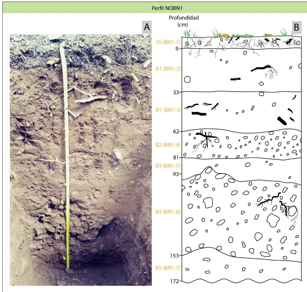
Figura 4.2: Perfil de suelo sitio NOBN1. A. Fotografía calicata; B. Perfil esquemático, mostrando los 7 horizontes desde Oi a B5 (letras naranjas).
