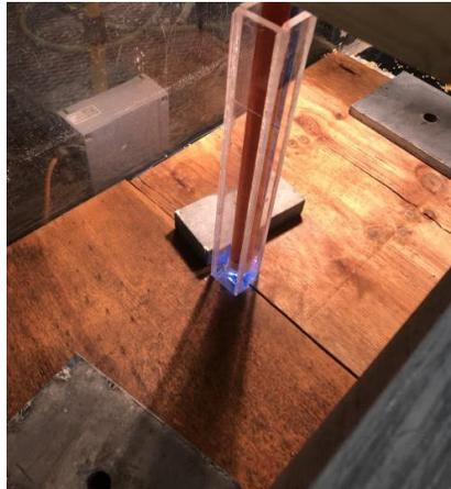
Figura 3.7 Sistema para evitar la socavación previa al ensayo
