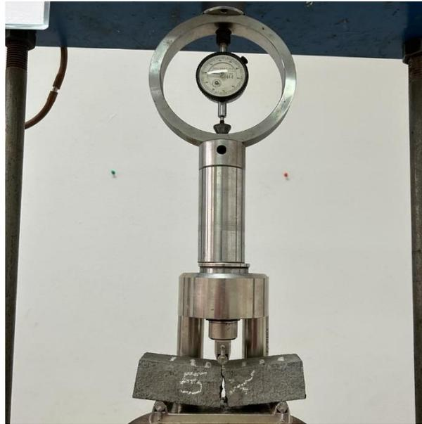
**Figura 4.12** Probeta de 5% de reemplazo ensayada.
