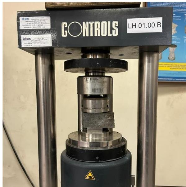
**Figura 4.13** Ensayo de compresión a probeta.
