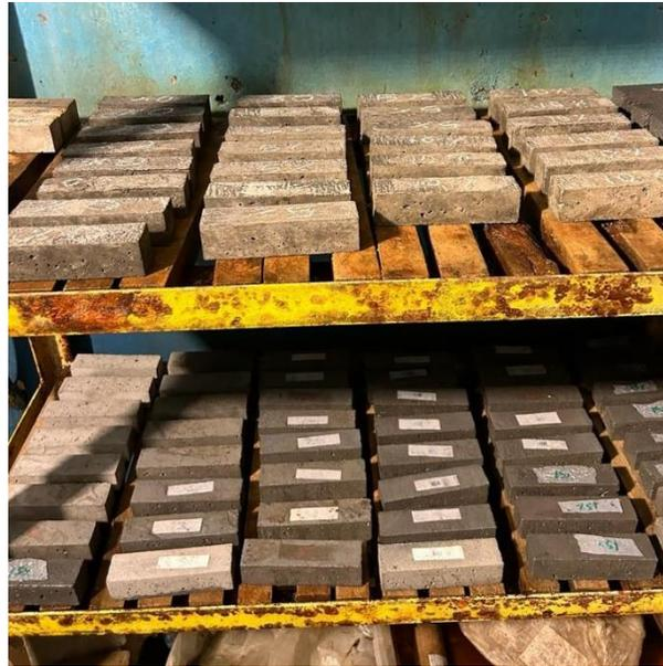
Figura 4.11 Probetas en cámara de curado
