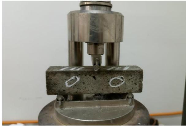
**Figura 4.8: Ensayo de flexión.**
