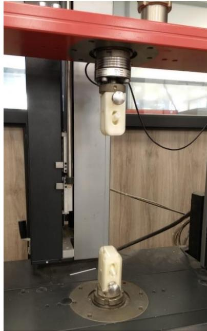
**Figura 4.3:** Ensayo de tracción de fibra plástica en máquina de ensayos universales ProLine Z005.
