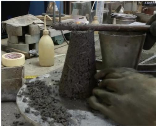
Figura 4.7: Ensayo de cono de Abrams.
