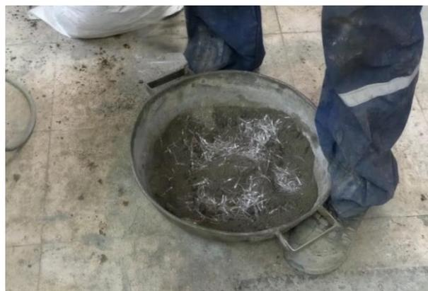
**Figura 4.4:** Amasado de la mezcla con fibra PET.
