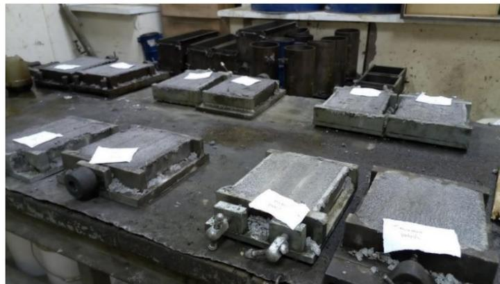
**Figura 4.6: Probetas listas para desmoldar.**
