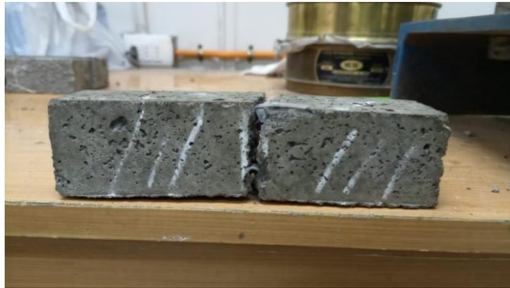
**Figura 5.5: Separación de las partes de probeta con agregado de fibra PET.**
