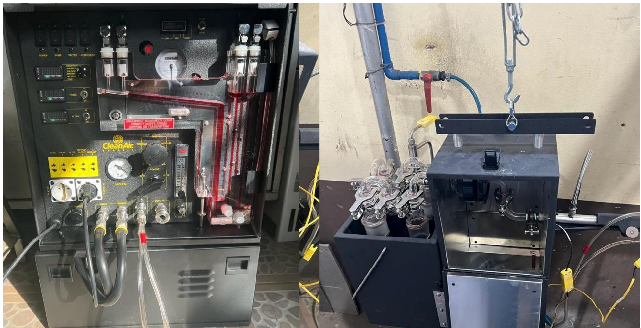
Figura 3.9 Tren de muestreo de emisiones de MP por el Método isocinético.
