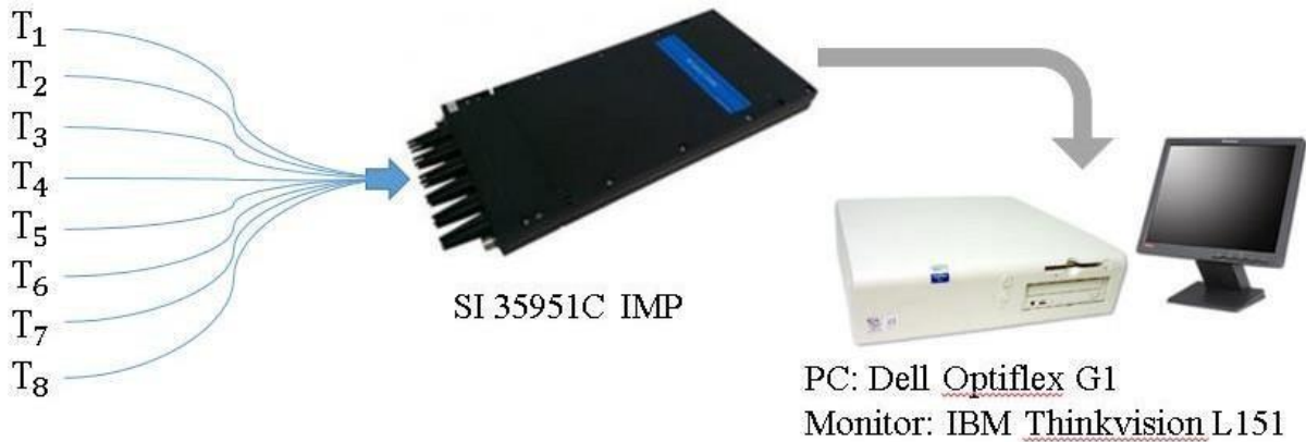
Figura 3.11 Sistema de registro de las temperaturas de las termocuplas.
