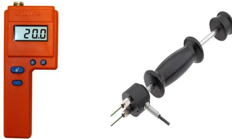
Figura 3.8 a) Delmhorst F-2000 equipo para el monitoreo de la humedad de la madera. b) Electrodo tipo martillo Delmhorst Electrodo 26-ES
