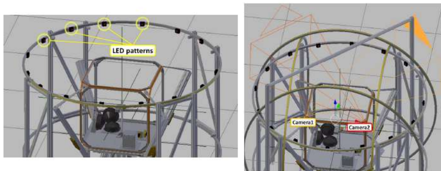
Figura 3.4: Star Simulator en FACE de DLR [21].
