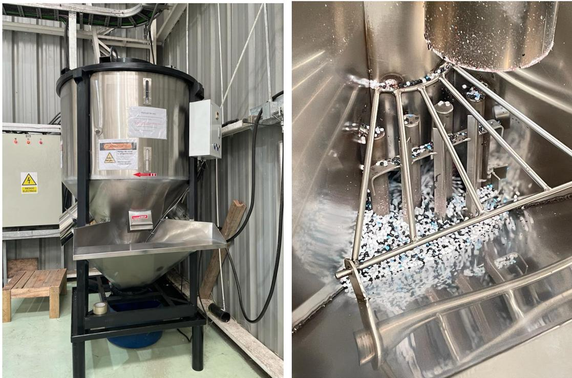
*Figura 8: A la izquierda a) Revolvedor y a la derecha b) mezcla que ingresa al revolvedor.*
