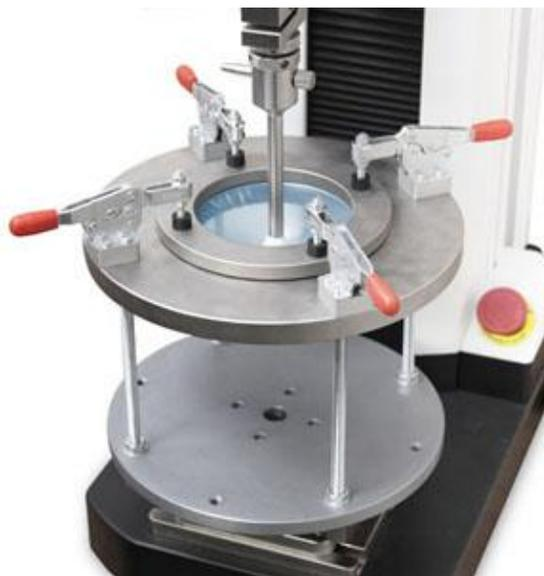
Figura 18: Ensayo de punción
