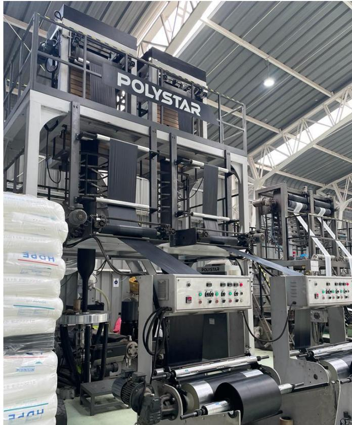
*Figura 16: Extrusora Polystar en la fabrica*
