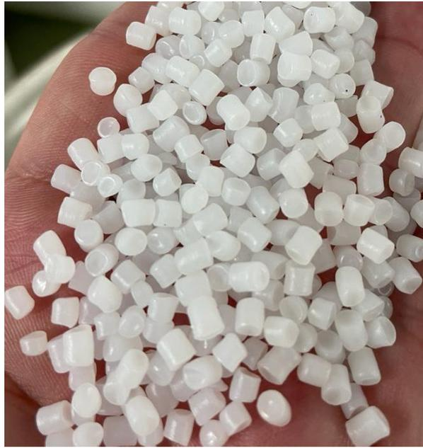
*Figura 13: Polietileno lineal de baja densidad.*
