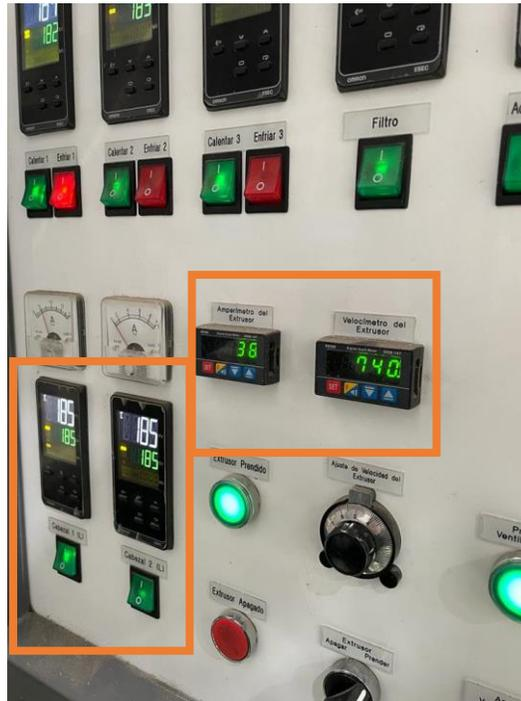
*Figura 9: Panel de control: a la izquierda a) Temperatura de resistencias, a la derecha b) velocidades.*
