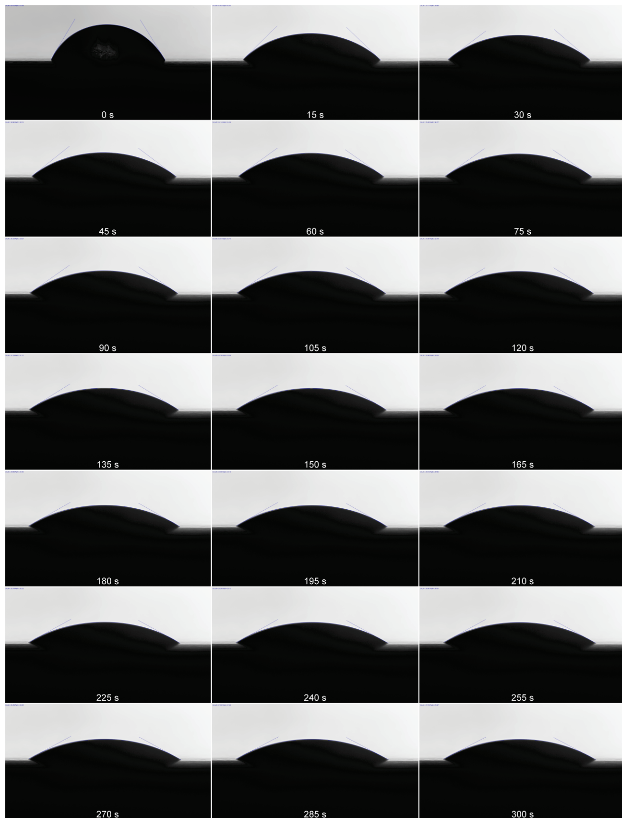
Figura B.10. Evolución del ángulo de contacto medido en la muestra del mineral de DGM durante la décima medición. De izquierda a derecha y de arriba hacia abajo, las imágenes representan el progreso en intervalos regulares a lo largo de la duración de la medición.
