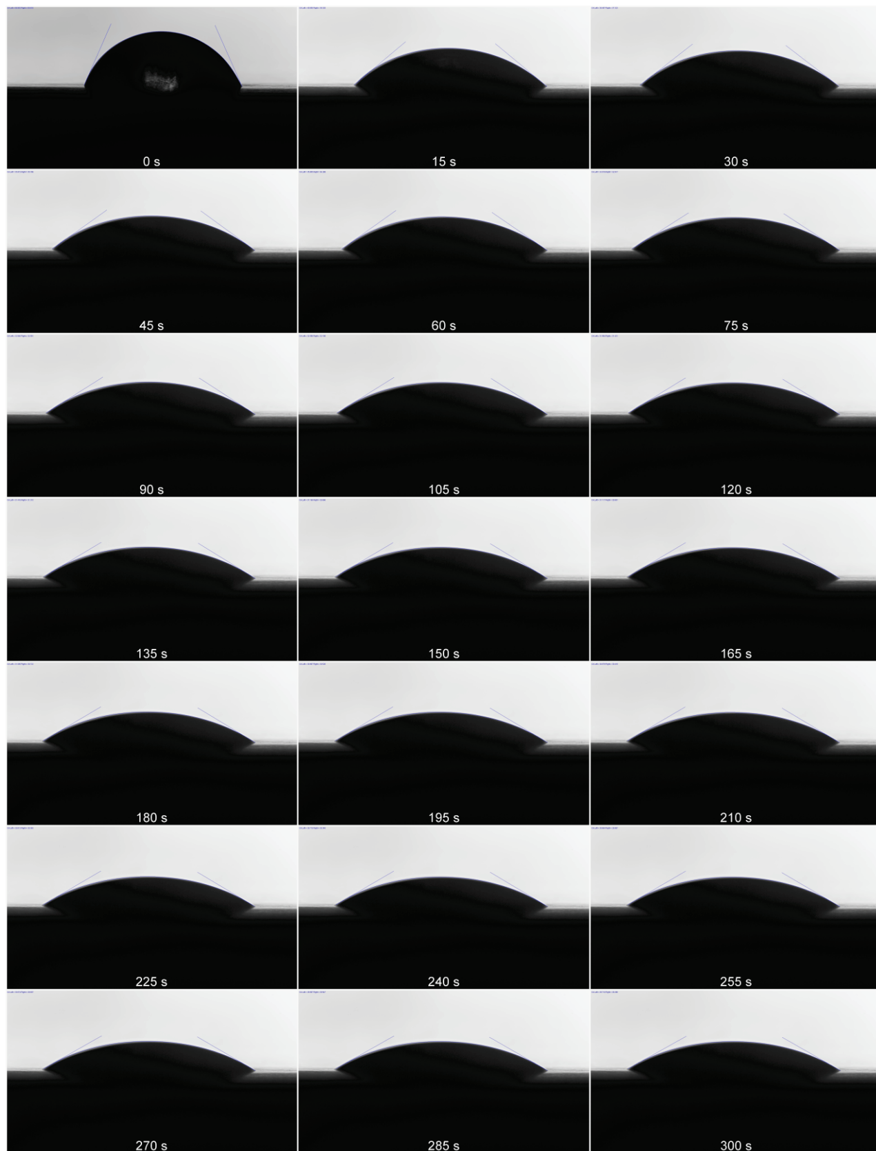
Figura B.7. Evolución del ángulo de contacto medido en la muestra del mineral de DGM durante la séptima medición. De izquierda a derecha y de arriba hacia abajo, las imágenes representan el progreso en intervalos regulares a lo largo de la duración de la medición.
