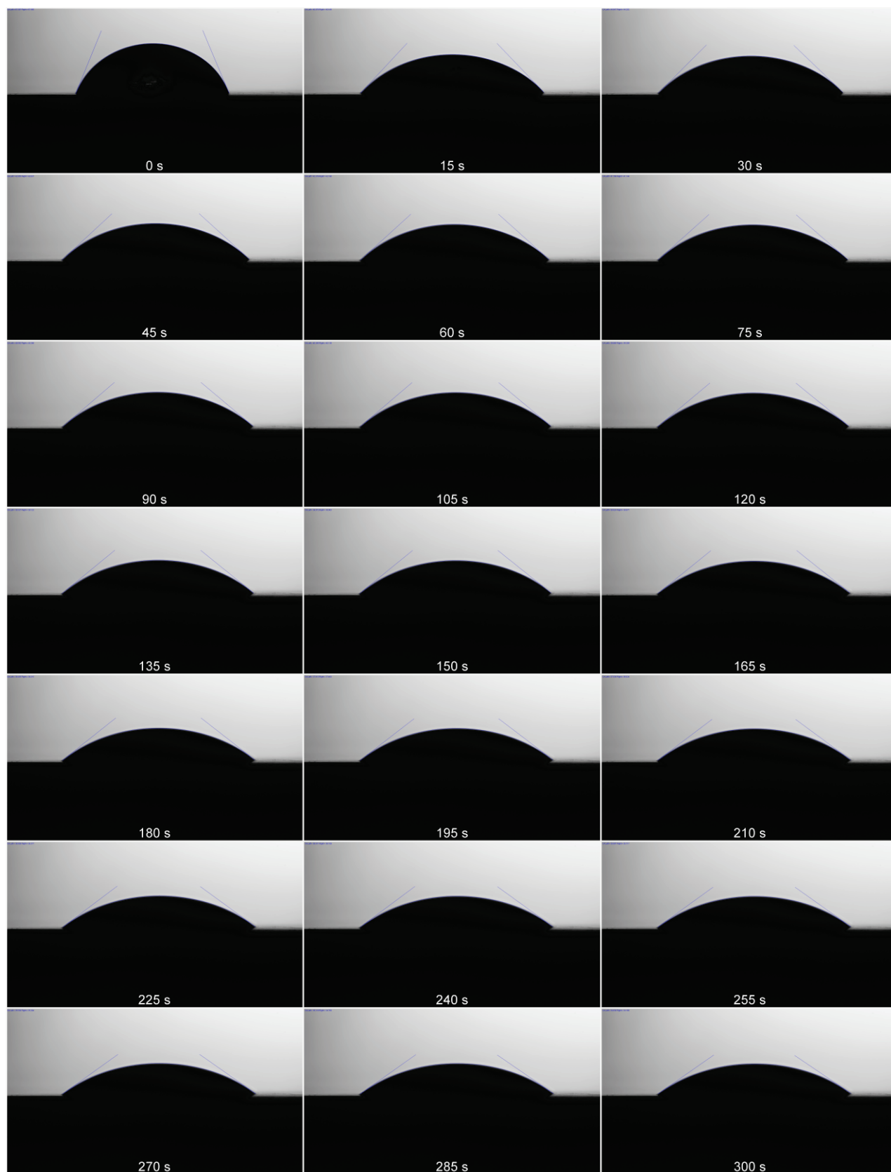
Figura B.6. Evolución del ángulo de contacto medido en la muestra del mineral de DGM durante la sexta medición. De izquierda a derecha y de arriba hacia abajo, las imágenes representan el progreso en intervalos regulares a lo largo de la duración de la medición.
