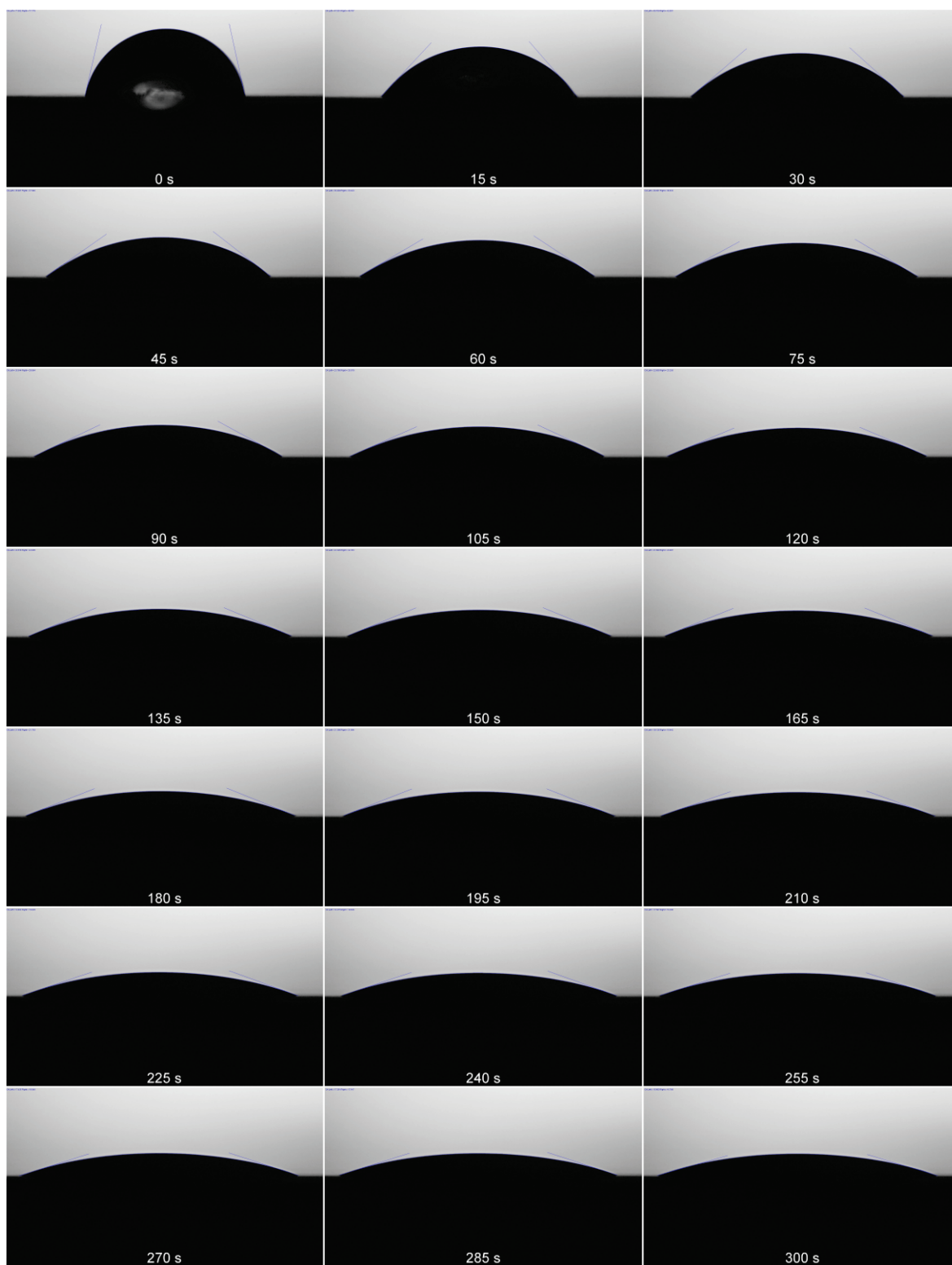
Figura B.1. Evolución del ángulo de contacto medido en la muestra del mineral de DGM durante la primera medición. De izquierda a derecha y de arriba hacia abajo, las imágenes representan el progreso en intervalos regulares a lo largo de la duración de la medición
