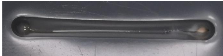
Figura 39: Forma final ensayo con velocidad de avance de 1000 mm/min y rotación de 200 RPM.
