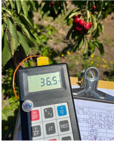
Figura 7. Temperatura interna (°C) del fruto cuando se encuentra en el árbol medida con el termómetro digital UEI DT130.
