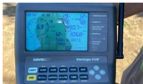
Figura 13. Estación meteorológica DAVISI Vantage VUE, que se encuentra en el interior del predio Santa Elena.
