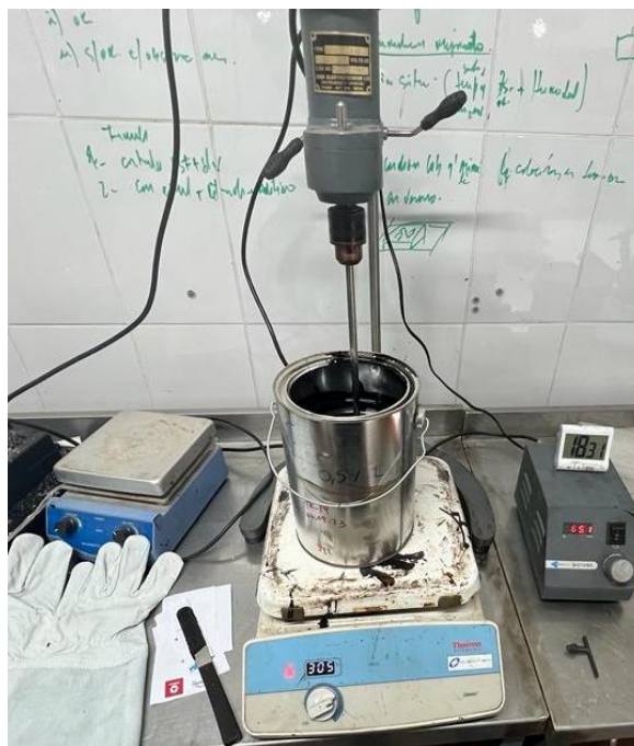
Figura 3-2 Mezclador rotacional. Fuente: Elaboración propia
