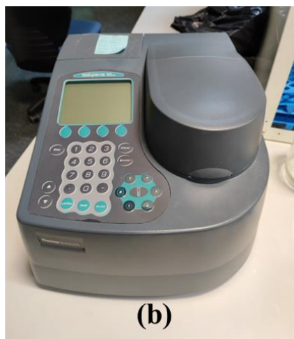
Figura 7.17: (a) Baño de ultrasonidos (Elmasonic, S 40 H, Alemania), (b) espectrofotómetro UV visible (Genesys 10 UV, Thermo Spectronic, USA).
