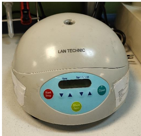
Figura 7.16: Minicentrífuga utilizada en la experimentación (HW12, Lan technic)
