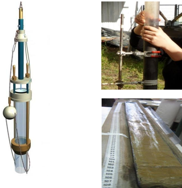
Figura 5. Muestreador de gravedad Uwitec. Seccionamiento de los núcleos sedimentarios.
