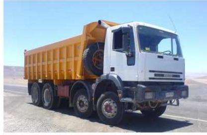
Figura 3.6 Camión de 20 m<sup>3</sup>.
